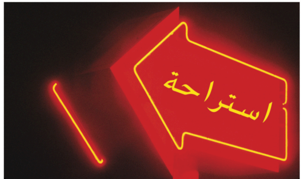
الشكل 6 البلازما تصدر ضوءاً عند نقلها للكهرباء. اللون الذي يصدر عن البلازما المتوهجة يعتمد على نوع الغاز داخل الأنبوب.
