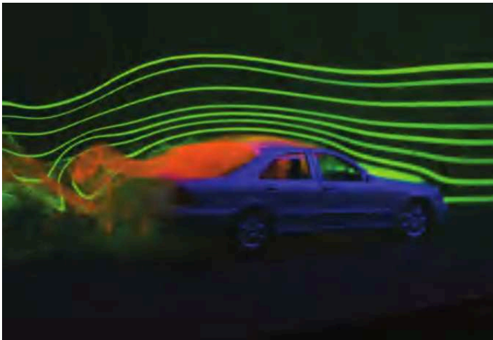
الشكل 17 :- خط الجريان يوضح الهواء المتدفق فوق السيارة في نفق هواء.
