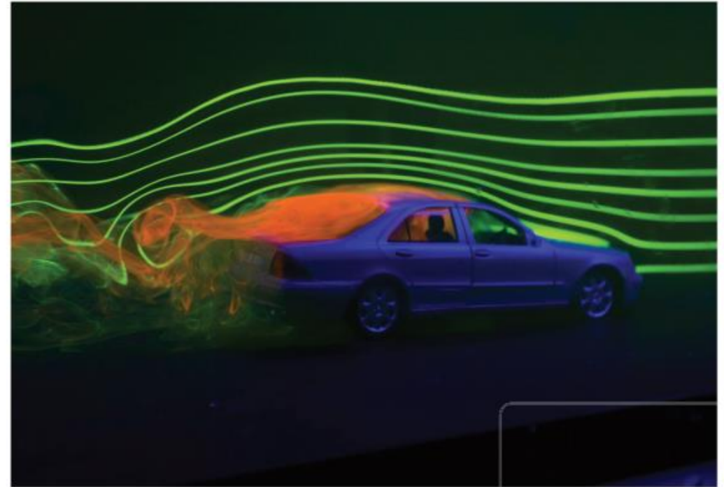
الشكل 17 خط الجريان يوضح الهواء المتدفق فوق السيارة في نفق هواء.
