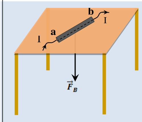
وضع موصل مستقيم (a b) طوله (0.12m) فوق سطح طاولة أفقي كما في الشكل المجاور، وعندما أمر فيه تياراً مستمراً شدته (6.0 A) تأثر بقوة مغناطيسية مقدارها (0.40N) في اتجاه عمودي على سطح الطاولة نحو الأسفل. **احسب أقل** مقدار لشدة المجال المغناطيسي المنتظم الذي يؤثر في الموصل وارسم على الشكل خطوطه.
