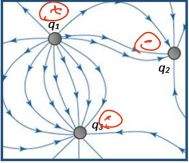
يوضح الشكل المجال الكهربائي لثلاث شحنات كهربائية  $q_1, q_2, q_3$ ، أي من صفوف الجدول الآتي يبين بشكل صحيح نوع كل من الشحنات؟
