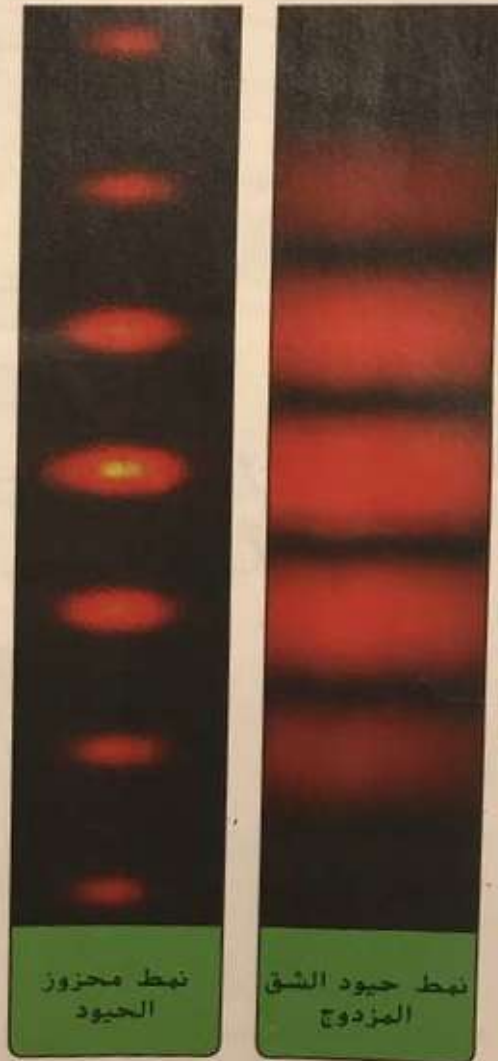
الشكل 18 يوضح الشكل مقارنة بين نمطي الحيود للضوء الأحمر. يوفّر نمط محزوز الحيود قياساً أكثر دقة.
