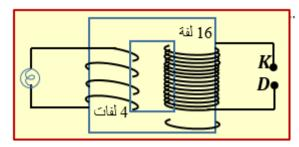
21) استخدم محوّل كهربائي لإضاءة مصباح كهربائي وتم وصله كما هو مبيّن في الشكل المجاور.
