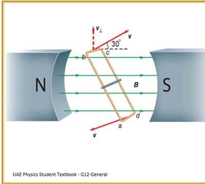
يبين الشكل مولداً كهربائياً تتولد فيه قوة دافعة كهربائية مستحثة EMF تتغير قيمتها باستمرار نتيجة دوران الملف داخل مجال مغناطيسي. إذا كانت أقصى قيمة للقوة الدافعة الكهربائية المستحثة في المولد تساوي 16 V، ما مقدار القوة الدافعة المستحثة EMF في اللحظة المبينة في الشكل؟
