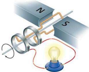
مولد تيار متردد يزود مصباحاً كهربائياً بقدرة متوسطة  $P_{AC}$  مقدارها  $90.0 \text{ W}$ .
