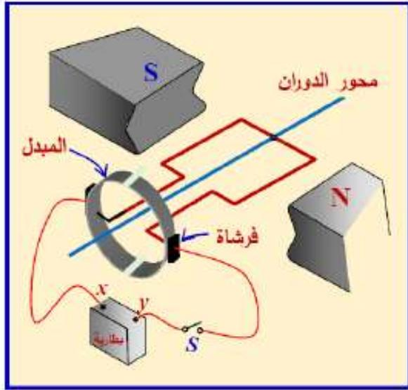
يظهر الشكل المجاور رسماً تخطيطياً لمحرك كهربائي
