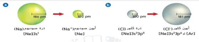
الشكل 13 يوضح كيف يختلف حجم الذرات اختلافًا كبيرًا عندما تكون أيونات. أ. الأيونات الموجبة أصغر من الذرات المتعادلة المكونة لها. ب. الأيونات السالبة أكبر من الذرات المتعادلة المكونة لها.
