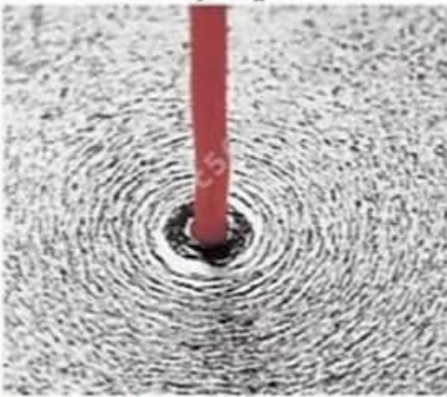
المجال المغناطيسي المحيط بسلك
