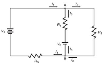
❖ **تذكر أن:** ▪ القدرة ←  $P = \frac{\Delta V^2}{R} = I^2 R = I V$  ، لذا في دوائر التوالي ← تتناسب القدرة طردياً مع المقاومة (لثبات التيار).
