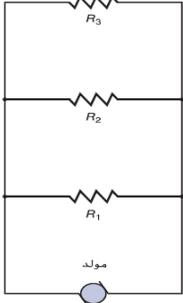
➤ **دوائر التوازي** هي الدوائر الكهربائية التي يكون فيها العديد من مسارات التيار.
