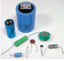
**المكثف** : هو جهاز يستخدم لتخزين الطاقة واسترجاعها لحظياً عند الحاجة إليها .
