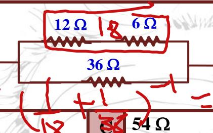
الشكل المجاور يبين مجموعة من المقاومات تم توصيلها فإن المقاومة لها تساوي :
