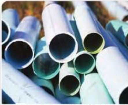
يستخدم غاز الكلور في تصنيع منتجات بولي كلوريد الخيل كل تلك الأنابيب من أجل توزيع المياه.
