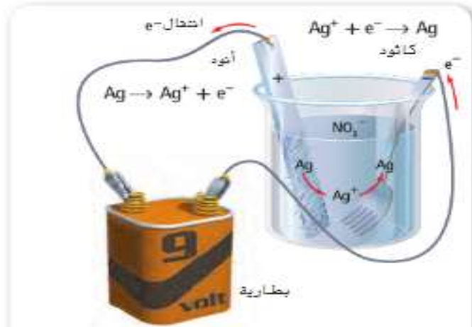
الشكل 23 يجب توفير طاقة لتأكسد الفضة عند الأنود واختزال الفضة عند الكاثود. في عملية التحليل الكهربائي التي تستخدم للطلاء بالفضة، يكون الجسم المراد طلاؤه هو الكاثود حيث تختزل أيونات الفضة في محلول الإلكتروليت إلى فلز الفضة ويطلق بيا الجسم المراد طلاؤه.
