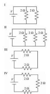
الدوائر الموضحة أدناه متصلة بمصادر الطاقة التي توفر نفس الجهد الكهربائي V
