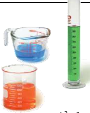
يمكن قياس حجم سائل باستخدام اسطوانة مدرجة أو دورق أو كأس قياس.
