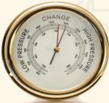
الباروميتر يستخدم لقياس ضغط الهواء.
