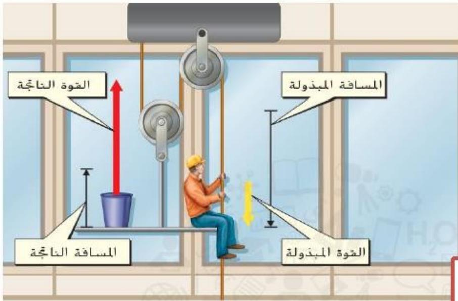
**الشكل 20** يرفع عامل تنظيف النوافذ منصته باستخدام نظام بكرة تزيد المسافة التي تُبذل القوة خلالها وتقلل القوة المبذولة المطلوبة وتغير اتجاهها.
