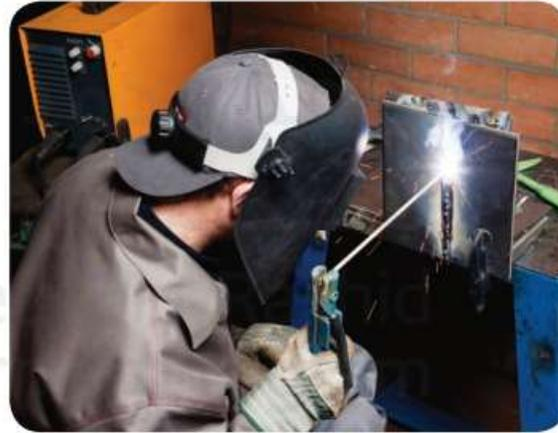
يُنتج التفريغ الكهربائي الثابت بين الساق الفلزي والصفائح الغولاذية طاقة حرارية كافية لصهر الفلزات.
