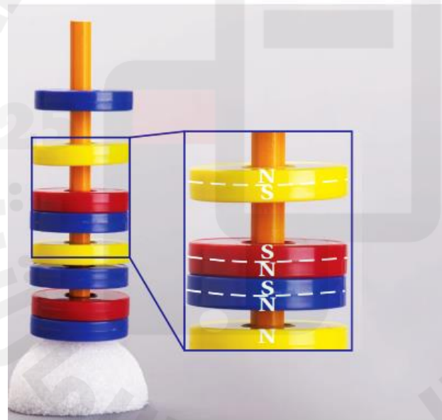
الشكل 15 تتنافر الأقطاب المغناطيسية المتشابهة أو المتماثلة؛ وتتجاذب الأقطاب المغناطيسية المتعاكسة.
