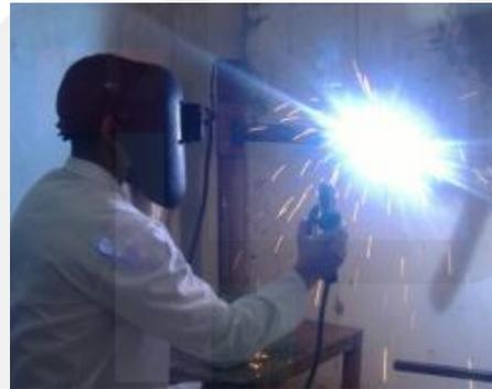
يُنتج التفريغ الكهربائي الثابت بين الساق الفلزي والصفائح الفولاذية طاقة حرارية كافية لصهر الفلزات.
