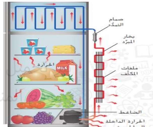
الشكل 15 ينقل السائل المبرد الطاقة الحرارية من داخل الثلاجة إلى خارجها.
