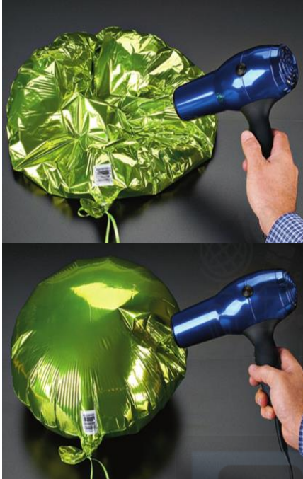
الشكل 9 يزداد حجم الهواء الموجود داخل البالون بازدياد درجة الحرارة.
