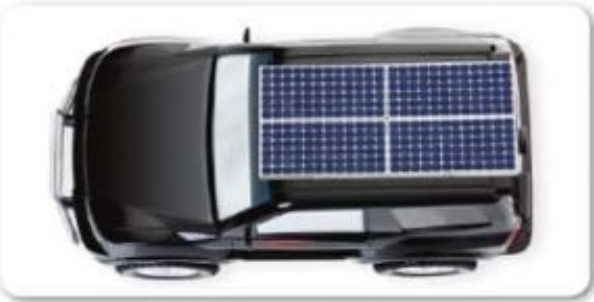
الشكل 17 تحوّل الخلايا الكهروضوئية الطاقة الإشعاعية إلى طاقة كهربائية. لبعض الموديلات أواج كهروضوئية اختيارية مصنوعة من خلايا شمسية تستخدم لتزويد السيارة من دون استخدام المحرك.
