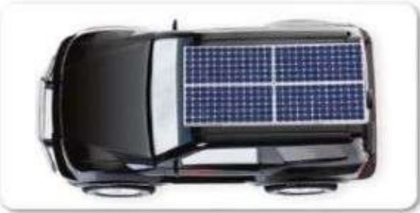
الشكل 17 تحوّل الخلايا الكهروضوئية الطاقة الإشعاعية إلى طاقة كهربائية لبعض الموج الكهروضوئية اختياريّة مصنوعة من خلايا شمسية تستخدم لتزويد السيارة من دون استخدام المحرك.
