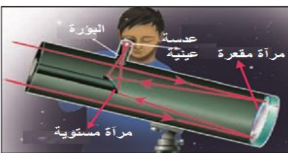
في المنظار الفلكي العاكس تقوم مرآة مقعرة بتجميع الضوء لتكوين صورة تقع بين البؤرة الأصلية والمركز البصري للعدسة العينية.
