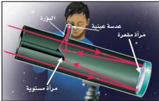
في المنظار الفلكي العاكس تقوم مرآة مقعرة بتجميع الضوء لتكوين صورة تقع بين البؤرة الأصلية والمركز البصري للعدسة العينية.
