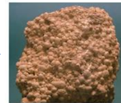
الصورة ٦-٤ البوكسيت: الخام الرئيسي للألمونيوم. ويكون في العادة مخلوطاً مع أكسيد الحديد (III)، الذي يعطي الخام لونه البني المحمر
