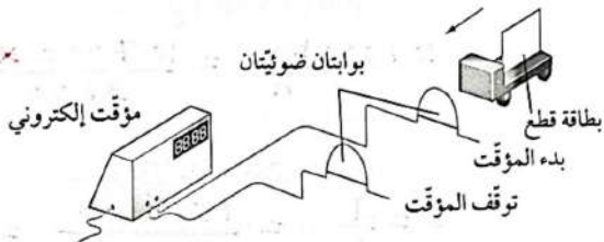
الشكل ٢-١: للسؤال ٢. تحديد السرعة باستخدام بوابتين ضوئيتين.
