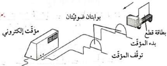
الشكل ٢-١: للسؤال ٢. تحديد السرعة باستخدام بوابتين ضوئيتين.
