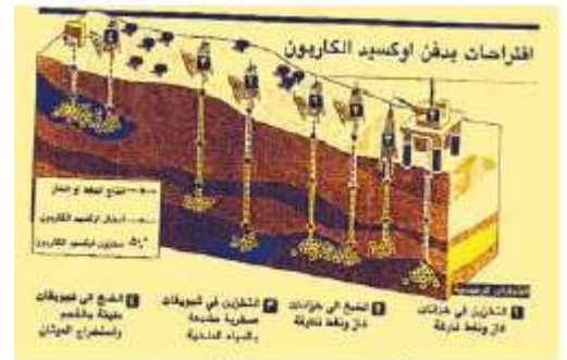
الشكل (٨) : طرق حجز الكربون ودفنه.
