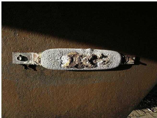
قطعة خارصين مُلتصقة بهيكل سفينة من الحديد . تأكسدَ الخارصين بينما بقي الحديد دون أيّ ضرر. أُجذت الصّورة من ويكيبيديا .
