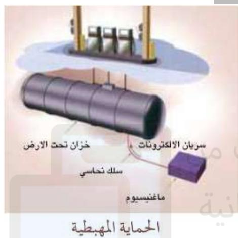
تستخدم هذه الطريقة لحماية الخزانات وأنباب نقل البترول المدفونة تحت سطح الأرض أو السفن والقوارب التي يغمر جزء منها تحت سطح الماء من الصدأ (الشكل) وذلك بتوصيل أجسامها بكتل من الخارصين أو الماغنيسيوم ، حيث يعمل الحديد كمهبط خلية جلوفانية يكون فيها الخارصين أو الماغنيسيوم مصدرا .
