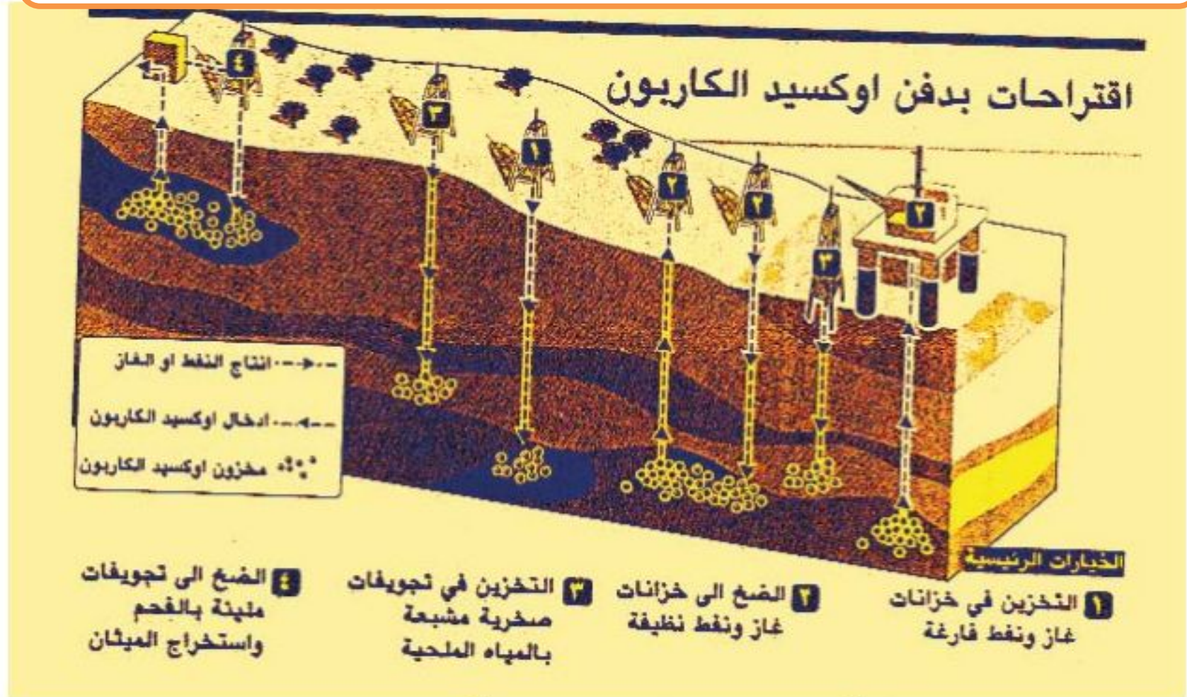
الشكل (٨) : طرق حجز الكربون ودفنه.
