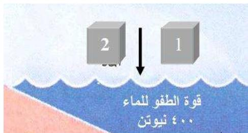
٣. يوضح الشكل المقابل نتائج تجربة لقياس طفو مكعبين في الماء حيث ان وزن المكعب الاول (٣٥٠ نيوتن) و وزن المكعب الثاني (٤٥٠ نيوتن).
