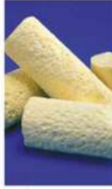
يُضاف الكبريت للمطاط لجعله صلبًا.
