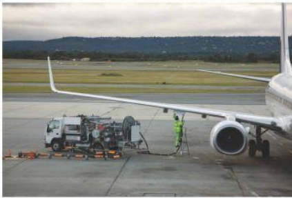
تحتاج الطائرة إلى الإمداد بالطاقة؛ لذا تستخدم وقود الكيروسين.
