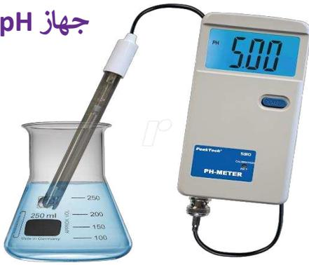
يستخدم قطب كهربائي (إلكترود) لقياس الرقم الهيدروجيني كهربائياً
