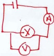
٣- في الشكل المجاور عند غلق المفتاح في الدائرة أضي المصباح لمدة نصف دقيقة. تدفقت خلاله شحنة قدرها 3C. احسب شدة التيار الكهربائي بوحدة الأمبير (A)؟
