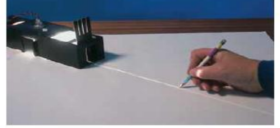
الصورة ١٢-١ : يُتيح صندوق الأشعة الضوئية حزمة واسعة من الضوء، يمكن تضييقها للحصول على شعاع ضوئي ضيق باستخدام لوحة فلزية فيها شق
