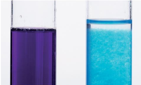
الصورة ٣-٥ تظهر الأنبوبة اليمنى نتيجة سلبية لاختبار بيوريت. وتظهر الأنبوبة اليسرى نتيجة إيجابية
