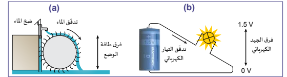
الشكل 8-5 (a) يُسبب فرق طاقة الوضع تدفقًا للماء، (b) يُسبب فرق الجهد الكهربائي تدفقًا للتيار الكهربائي.
