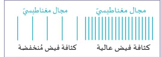
تُوضَّح خطوط المجال المغناطيسي اتجاه القوة المؤثرة على قطب اختبار شمالي تخيُّلي، ويكون اتجاهها دائماً من القطب الشمالي للمغناطيس إلى قطبه الجنوبي.
