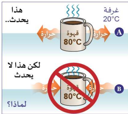
الشكل 5-24 تدفق الطاقة الممكن (a) والتدفق غير الممكن (b).
