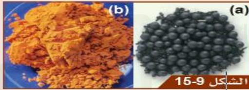
الشكل 9-15 تم استخلاص فلزّ الرصاص (الصورة a) من أكسيد الرصاص (II) الأصفر اللون (الصورة b).
