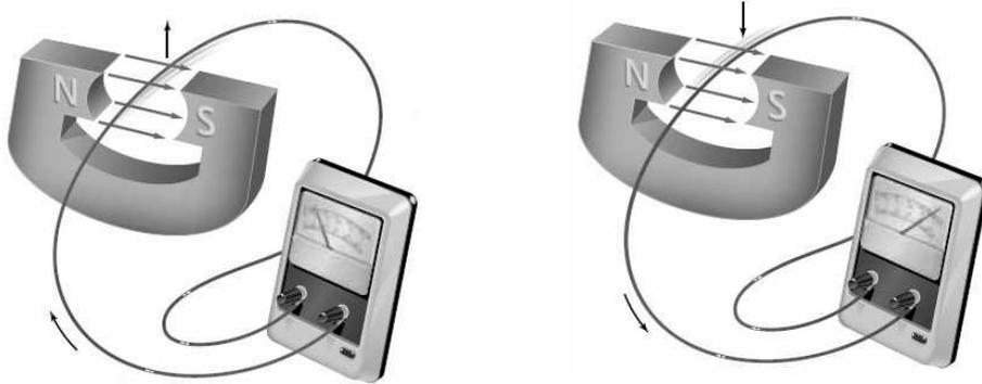
يسمى التيار الكهربائي في هذه الحالة ( تيار كهربائي حثي )
