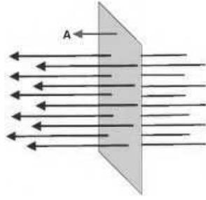
هو عدد خطوط المجال المغناطيسي التي تخترق السطح والتدفق يتناسب طردياً مع شدة المجال المغناطيسي كما بالشكل
