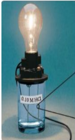
الشكل 3-11 يتوهج المصباح بقوة عندما يوضع القطبان في محلول حمض الهيدروكلوريك بتركيز 0.10\text{ M} لأن جميع \text{HCl} تتحلل إلى أيونات هيدروجين وأيونات كلوريد.
