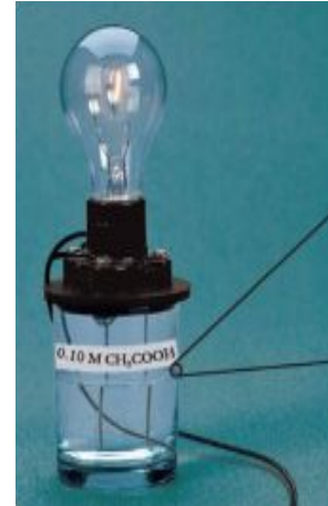
الشكل 3-12 عند وضع الأقطاب في محلول حمض الإيثانويك بتركيز 0.10\text{ M} يكون الضوء خافتاً. قارن هذه الصورة بالصورة بالشكل 3-11. فسر الفرق بين شدتي إضاءة المصباحين بحسب تركيز الأيونات في المحلول.
