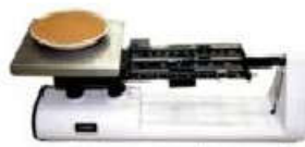
شكل ٦ - ميزان الأرفع يستخدم لقياس كتلة فرمطرية كتلة معلومة
