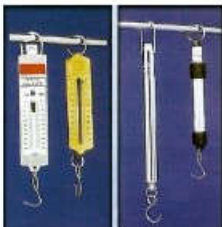
شكل ٦ - ميزان الأرفع يستخدم لقياس كتلة فرمطرية كتلة معلومة
