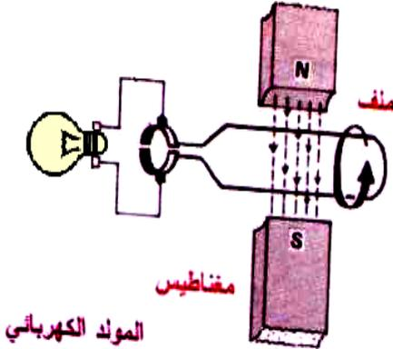
كيف يعمل المولد الكهربائي لإنتاج التيار الكهربائي :
